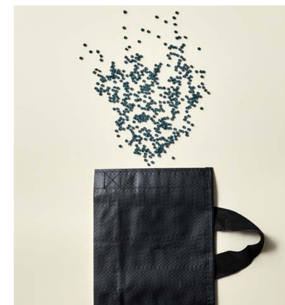
回收利用防水布制成的PCR PVC
