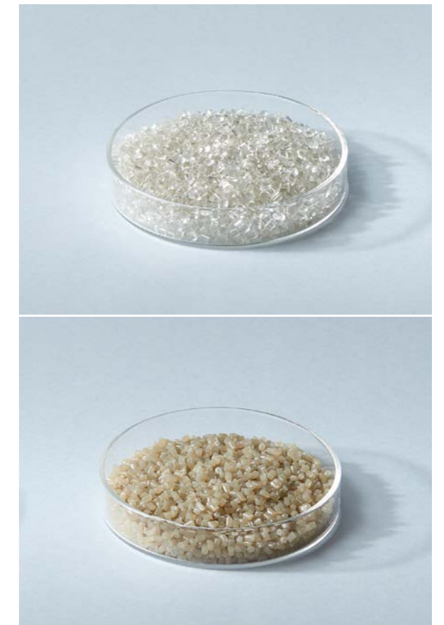
用海洋废塑料瓶和渔网制成的OBP PET和OBP PA颗粒
