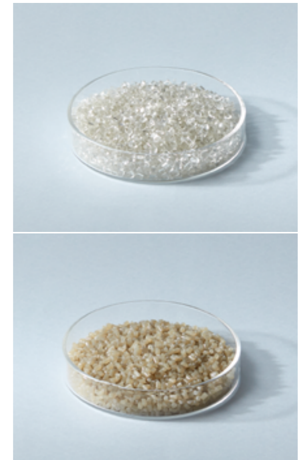
用海洋废塑料瓶和废渔网制成的OBP PET和OBP PA颗粒
